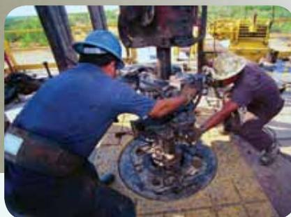
Противозадирная паста *Molykote*<sup>®</sup> с твердыми не содержащими металлов смазками снижает истирание резьбы на вращающемся бурильном оборудовании и помогает соблюдать производственный график.
